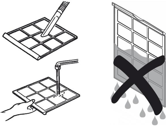
3. Deje que el filtro se seque completamente. No coloque nunca el filtro en el aparato mientras esté húmedo.
