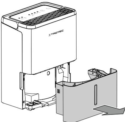
2. Vacíe el depósito de agua condensada en un desagüe o un fregadero.
