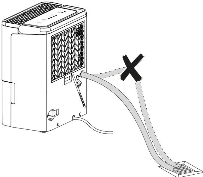
Cuando desee volver a recoger el agua condensada en el depósito quite la manguera. Deje secar la manguera antes de guardarla. La manguera puede ser conectada de manera permanente en cualquier modo de funcionamiento.
